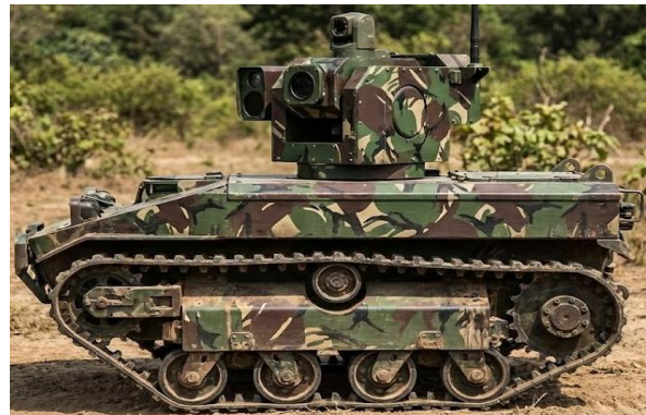
Gambar 1. Realisasi fisik Robot Pengintai Taktis dengan fitur kamuflase militer dan modul kamera turret yang dapat berputar.
